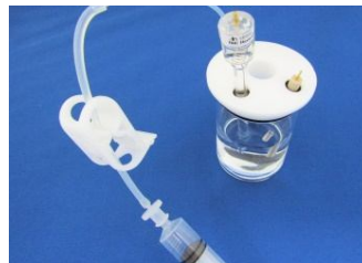
3.ピンチコック(b)を開いた状態でディスポーザブルシリンジ(d)を使用し、溶液をRHE(a)内へ吸引します。気泡が入らないよう注意して下さい。シリンジ変換アダプター(c)に溶液が届いたところでピンチコック(b)を締めます。
