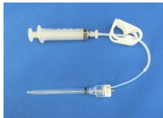
1.RHE 簡易型可逆水素電極(a)にピンチコック(b)、シリンジ変換アダプター(c)、ディスポーザブルシリンジ(d)、シリコンチューブ(e)を取り付けます。
