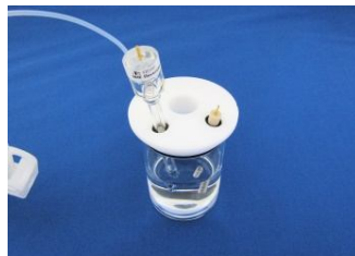
2.RHE(a)とPtカウンター電極(オプション:012961, 002233など)を酸性溶液の入った電解セルにセットします。
