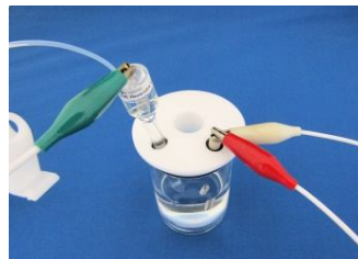
4.ポテンシオスタットを用意し、RHE(a)に作用電極端子、Ptカウンター電極に参照電極端子とカウンター電極端子を接続します。クロノアンペロメトリなどで電荷量が約2 Cになるまで電解を行って下さい。(例: 1.2 M 塩酸では設定電位-3 Vで約3分)
