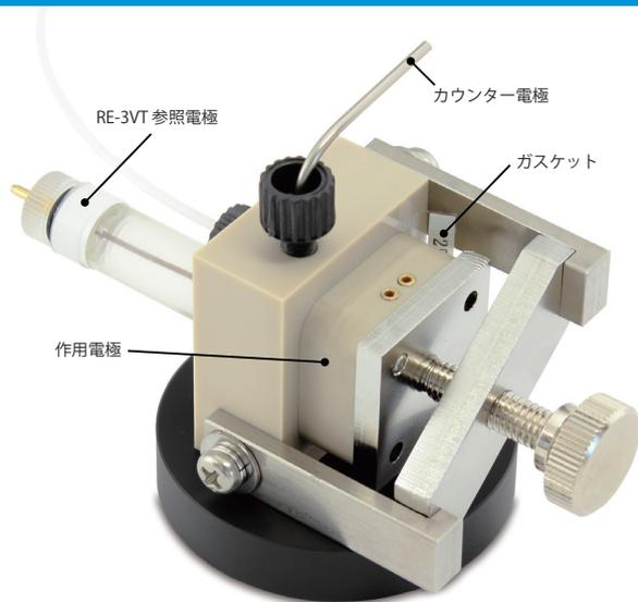
クロスフローセルでの溶液の流れは、電極表面上がクロスフローとなる最も一般的なアンペロメトリックセルです。クロスフローセルは 1 mL/min から 100  $\mu$ L/min までの流速で電気化学活性物質を  $10^{-15}$  mol (フェムトモル) レベルまで定量できます。
